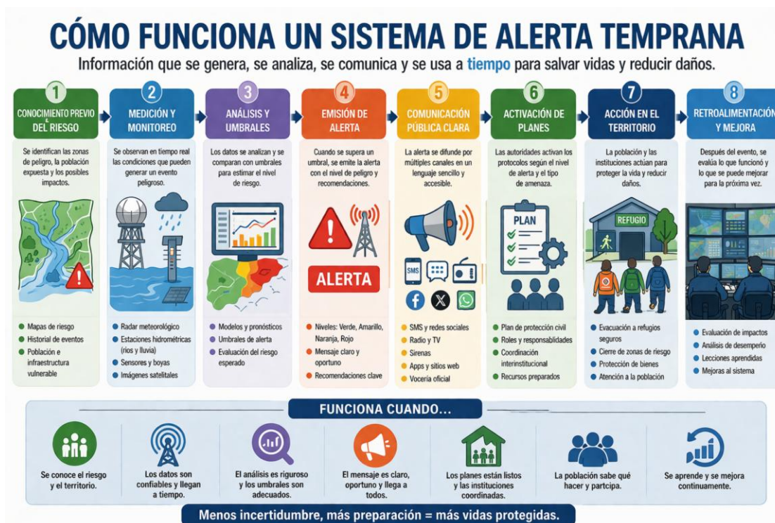
Figura 11. Funcionamiento general de un sistema de alerta temprana.
