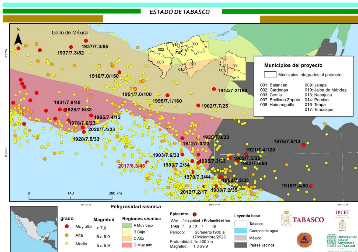
Figura 20. Regionalización sísmica de acuerdo con la Comisión Federal de Electricidad (S/F), con datos de los sismos con magnitud igual o mayor a 5 en la región de acuerdo a la base de datos del Sistema Sismológico Nacional.
