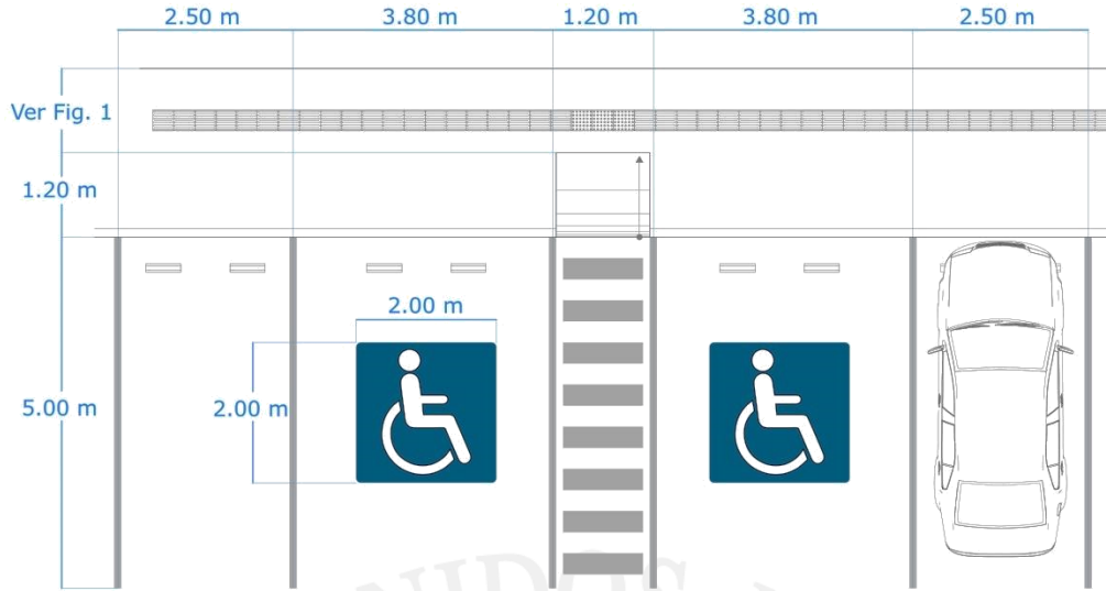
Figura 28 - Estacionamiento en batería
